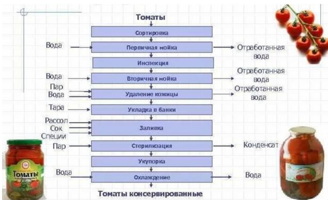
Рисунок 2 – Структурная схема производства томатных консервов
